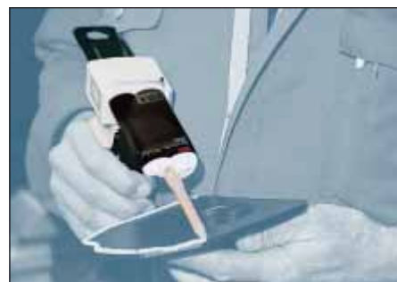
Klæbning af dele inde i en bil (PU) til instrumentbordet (PP) 3M Scotch-Weld DP8005
